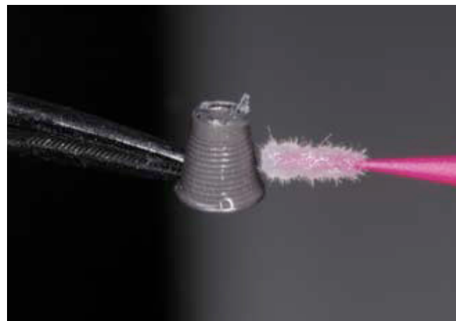
Fig. 54 - Tratamiento superficial con el primer bond específico de metal y zirconio
